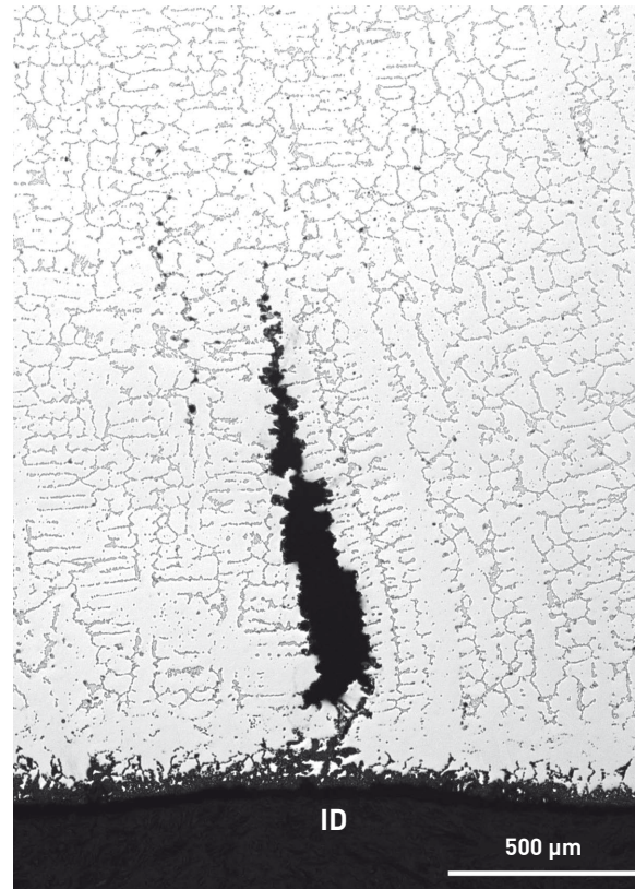
Figura 7: Microfotografía ampliada de fisura por fluencia
